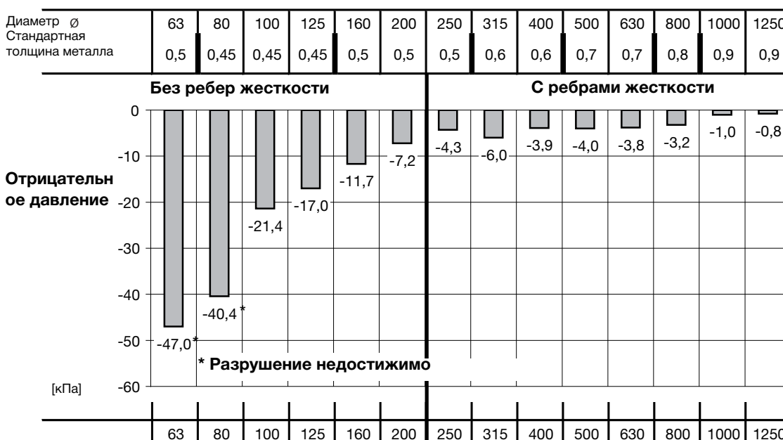
Разрушающее давление для воздуховодов типа SR
